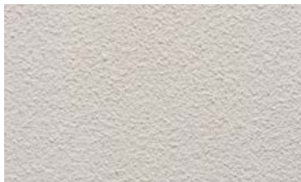
Mostra 2: Vopsitorie epoxidică presărată cu nisip de cuarț sort 0,1-0,5 mm
