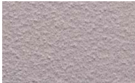
Mostra 8: Finisaj poliuretanic presărat cu nisip de cuarț 0,3-0,8 mm
