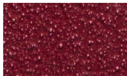
Mostra 6: Finisaj epoxidic presărat cu nisip de cuarț 0,6-1,2 mm
